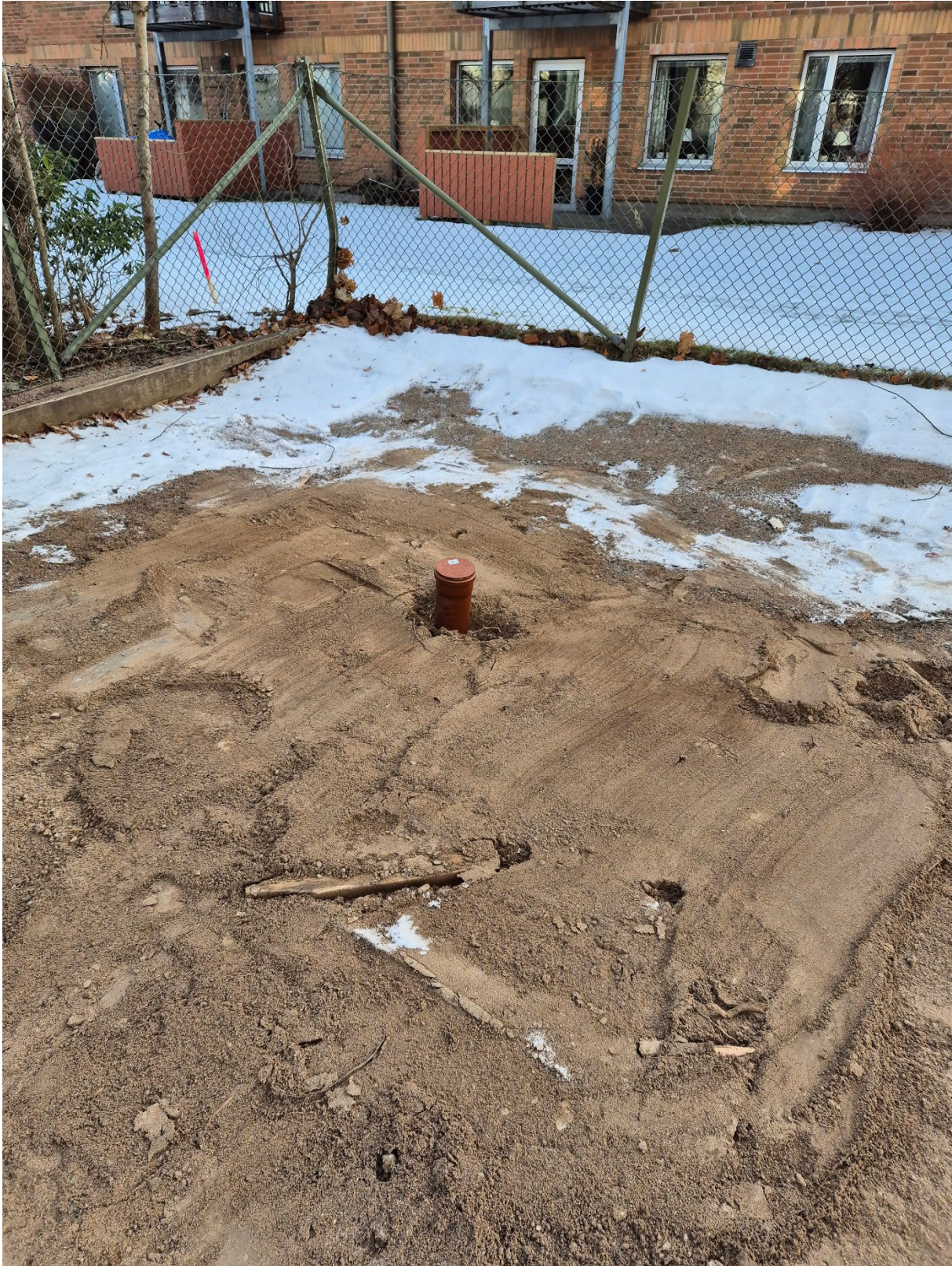
Figur 6: Provtagningspunkt C26 där radonrör är monterat. Bild där jordlagerföljd visas saknas.
