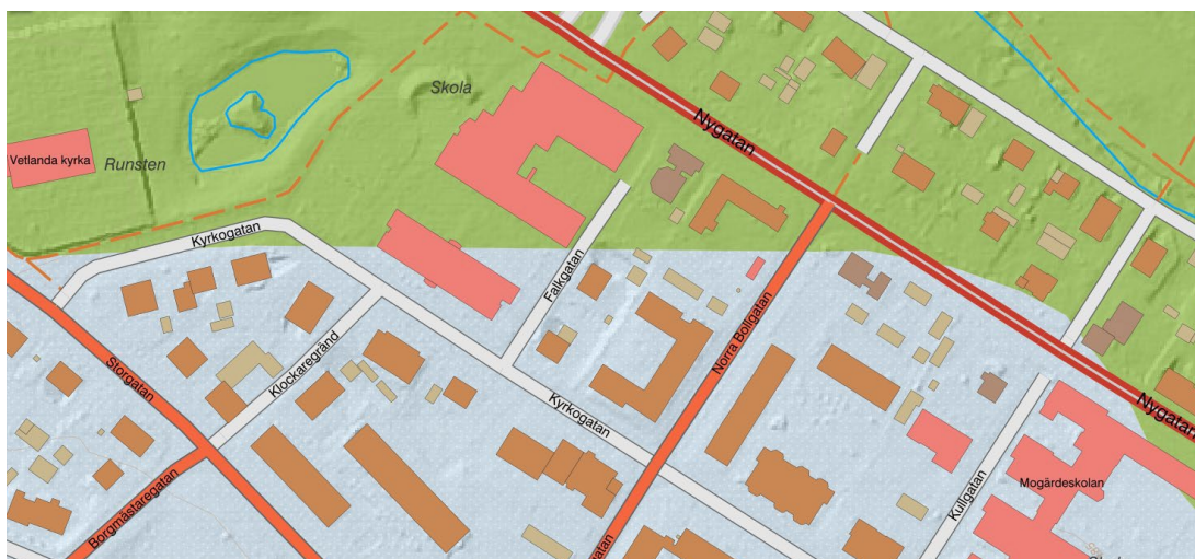
Figur 26: Utdrag ur jordartskarta. Blå färg indikerar sandig morän och grönfärgen indikerar isälvsedimentet. Källa: Sgu.se
