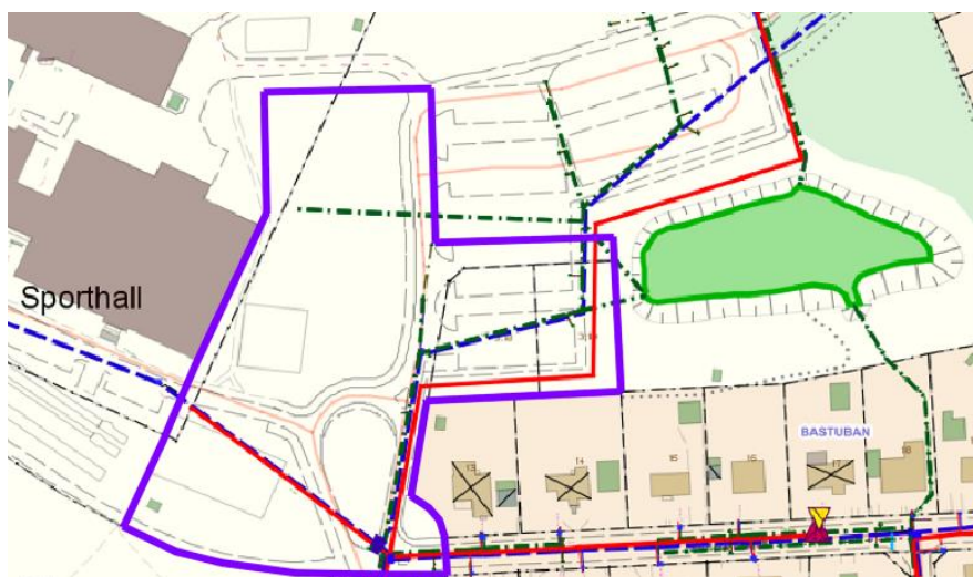
Figur 29: Kartan visar dagvattendammen öster om planområdet (den mörkgröna ytan i kartan) samt befintliga dagvattenledningar (med grönt streckade linjer) på fastighet Norrby 3:1 inom och utanför detaljplanensgränsen (markerad med lilafärgad kontur).
