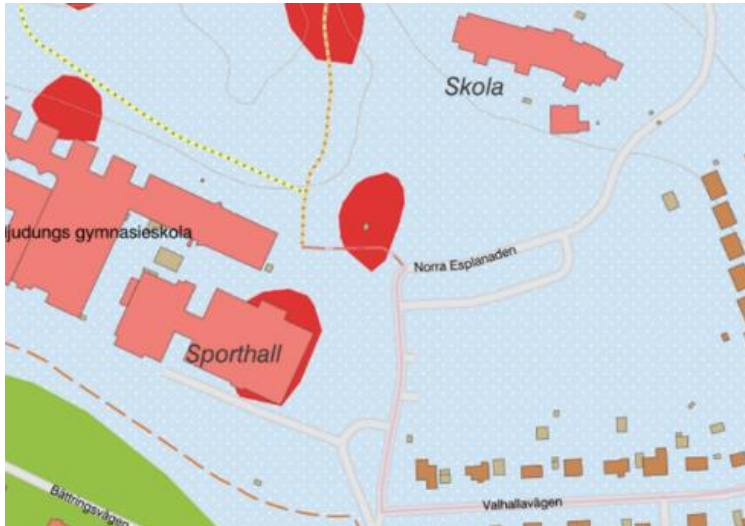
Figur 24: Utdrag ur jordartskarta. Blå färg indikerar sandig morän och röd färg indikerar berg. Källa: Sgu.se
