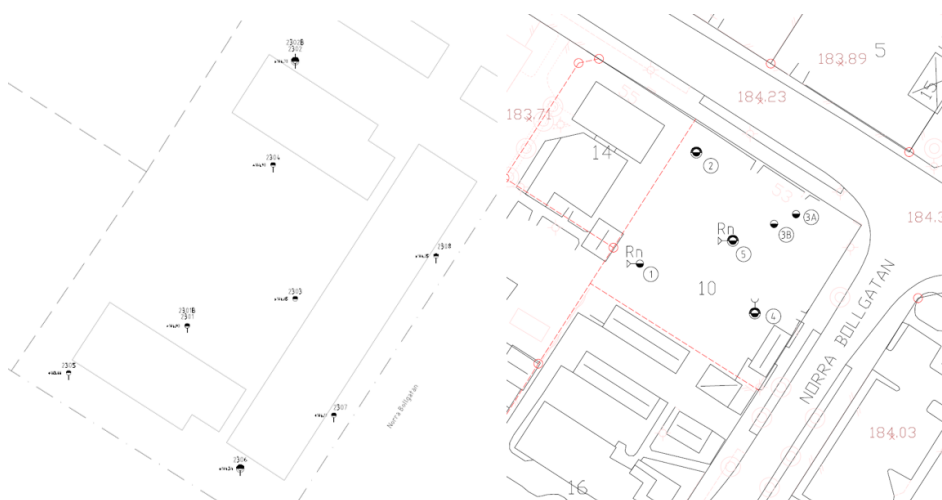
Figur 23: Sönderingspunkterna inom Falken 16 åt vänster. På bilden åt höger syns punkterna från den geoteknisk undersökning som gjordes 2013 inom fastigheten Falken 10
