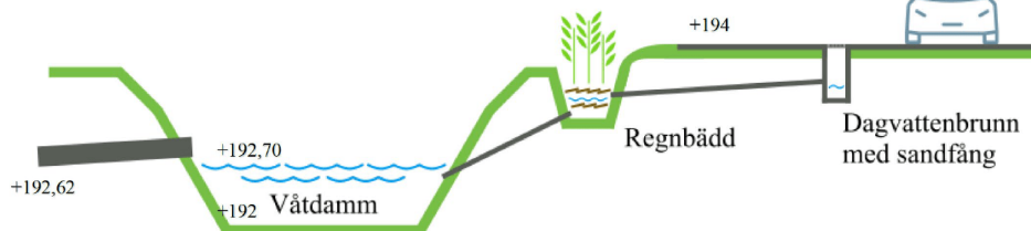
Figur 14: Principskiss för dagvattensystemet i den norra och södra delen av planområdet.
